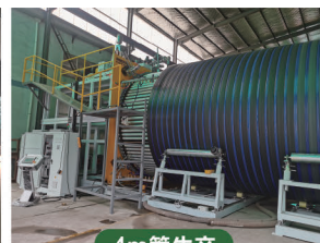
4m管生产 4m Pipe Production
